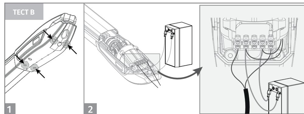
**Тест В** • Ослабьте 4 винта, чтобы снять крышку и получить доступ к внутренним подключениям. Выполните соединения, как показано на рисунке. Если мотор работает, проблема заключается в диоде (ах) или микропереключателе (ях). Если не работает, то замените на новый мотор 24V и повторите тестирование, чтобы убедиться, что все хорошо.
