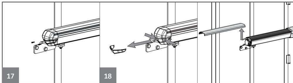
02 • Снимите хромированную часть с помощью отвертки.
