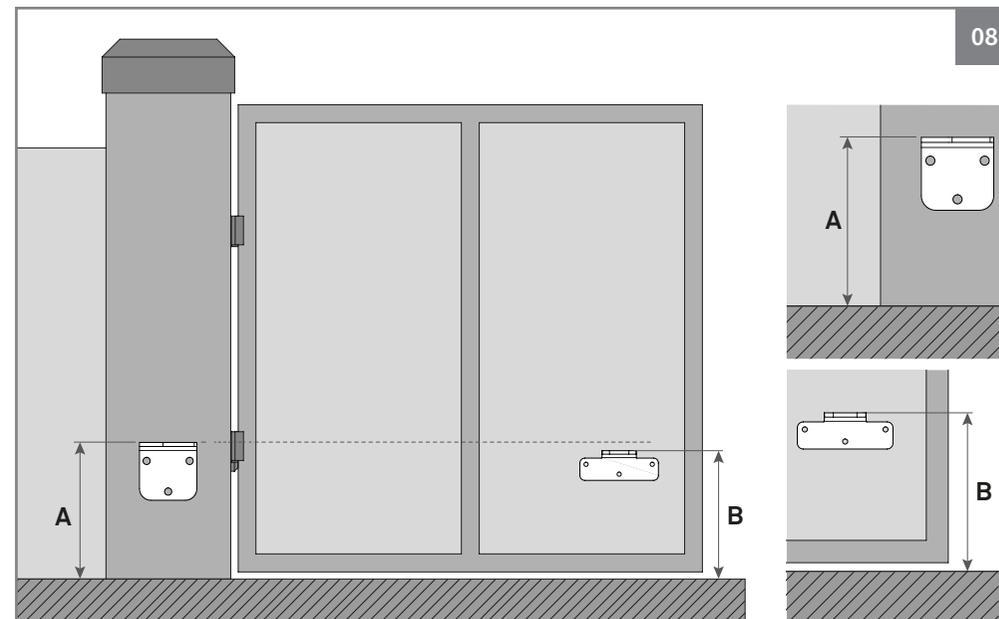
**Размер А** • вертикальное расстояние от пола до верхней части пластины заднего кронштейна.
