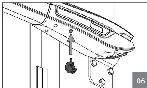
Поместите ключ разблокировки в отверстие, отмеченное на изображении 05 (мотор, установлен слева) или 06 (мотор, установлен справа).
