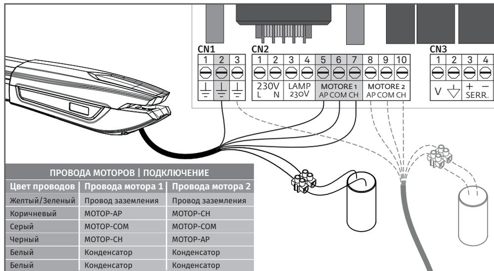
Соединения должны быть сделаны, как показано выше, подключив 6 проводов мотора к соответствующим входам в блоке управления и конденсаторе.
