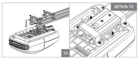
01 • Крепление автоматики к железной рейке возможно с использованием пластины и гаек M6, как показано на рисунке выше. Нужно закрутить 4 болта и оставить свободными 2 болта по средине.
