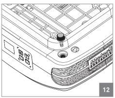
• Для замены предохранителя, сначала ослабьте его, как показано на рис. 11. Тогда просто потяните, чтобы снять его (рис. 12). Повторите те же действия в обратном порядке, чтобы установить новый предохранитель.
