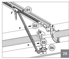
07 • Теперь прикрепите две пластины соединения между тележкой и пластиной верхней панели.
