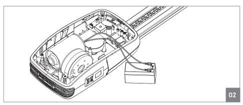
Кабели мотора не имеют специфического способа подключения. Разница лишь в том, что при подключении мотора в одну сторону, он будет вращаться в одном направлении, и если вы подключите провода противоположно, он будет вращаться в другую сторону.
