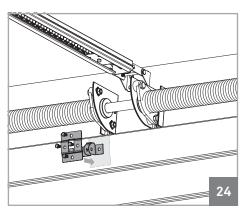
06 • Прикрепите пластину к верхней панели ворот. Пластина должна быть горизонтально по центру с панелью так, чтобы она совпадала с рейкой.
