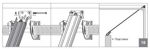
02 • Прикрепить рейку к фиксирующей пластине, которая уже установлена. Чтобы облегчить задачу, вы можете сделать это с наклоненной рейкой (мотор положить на подставку), которая облегчит установку, так как у вас есть только зона для фиксации рейки.
