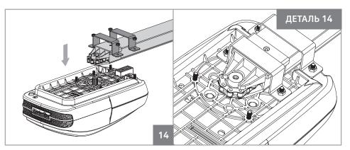
02 • Крепление автоматики к алюминиевой рейке возможно с использованием пластины и гаек М6, как показано на рисунке выше. Нужно закрутить 4 болта и оставить свободными 2 болта впереди.
