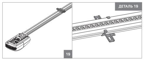
03 • Прикрепить пластину фиксации рейки к потолку по средине железной рейки, как видно на рисунках выше.
