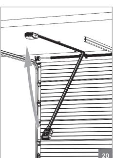
04 • Поднимите мотор до тех пор пока рейка не выровняется горизонтально. При необходимости, вы должны создать опорную конструкцию к твердой поверхности, как показано на предыдущей странице, так чтобы рейка выровнялась (рис. 17).
