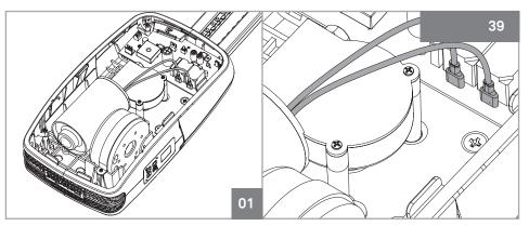
В случае отказа или сбоя в функционировании автоматики, необходимо обнаружить неисправный компонент (мотор или блок управления). Чтобы сделать это, вы должны проверить мотор, подключив его напрямую к источнику питания 24V DC.
