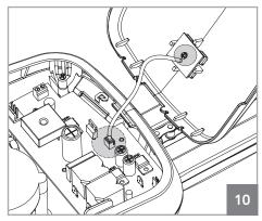
• Чтобы заменить плату светодиодов необходимо открыть верхнюю крышку и отсоединить провод светодиодов от блока управления. Ослабьте винты, удерживающие плату светодиодов на верхней крышке и снимите плату. Теперь просто поставьте новую плату светодиодов, прикрутите ее, вставьте провод в блок управления и опять поставьте крышку на мотор.
