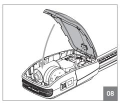
Если хотите установить крышку нужно сначала установить заднюю часть, как показано на рис. 07. Затем просто повернуть крышку и установить переднюю часть, нажав на нее. Защелки автоматически закрепят крышку.
