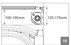
01 • Прикрепить опорную пластину рейки к перемычке, как видно на рис. 15. На рис.16 можно просмотреть расстояние, которое нужно соблюдать между рейкой ворот и верхней частью опорной пластины (125-175 мм).
