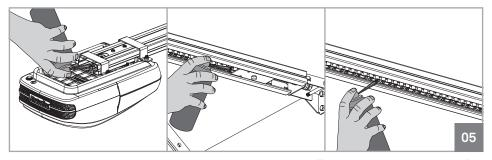
Необходимым условием обслуживания, является смазка осей движения автоматики и рейки. Шестерни на обоих концах рейки, а также поддерживающие их подшипники и цепи следует смазывать, по крайней мере один раз в год.
