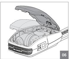
Чтобы снять крышку просто вставьте маленькую отвертку в боковые отверстия, и создайте эффект рычага, чтобы освободить отверствия между верхней крышкой и корпусом. Тогда просто снимите крышку, подняв ее.
