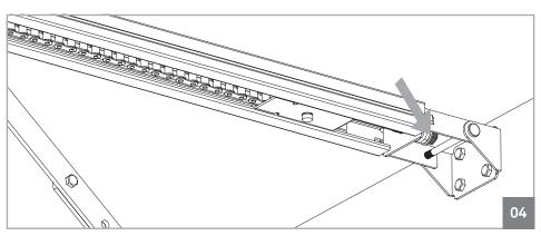
Для правильного функционирования автоматики, цепь должна быть отрегулирована. Для этого вам просто нужно затянуть или ослабить гайку, которая затемнена на рисунке выше, с помощью гаечного ключа, которая затянет или ослабит цепь.
