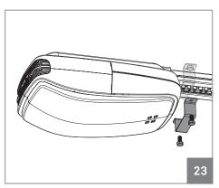
05 • После того как подняли рейку и отметили отверстия, нужно прикрепить пластину болтами. После этого, нужно использовать кабельные зажимы для усиления фиксации, на этот раз рядом с мотором (рис. 23).
